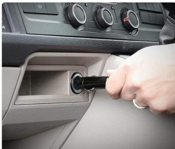
Krok 1: Podłącz wtyczkę zasilacza do gniazda zapalniczki
